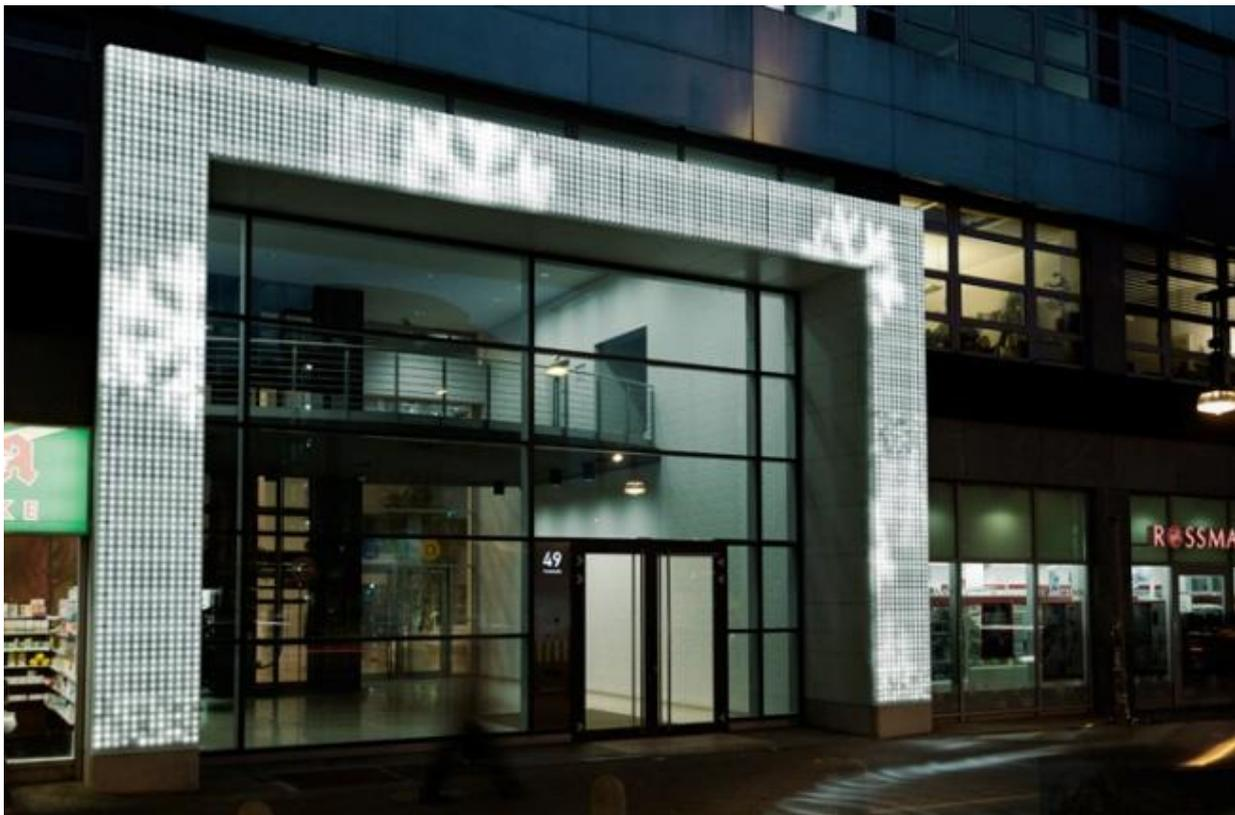
Die Besonderheit des Torbogens aus HI-MACS® ist die Transluzenz des Werkstoffs. Er ist aus Acrylstein in der Farbe Opal gefertigt. Die Platten lassen sich mit LEDs hinterleuchten. So lassen sich bewegliche Muster, Schriften und Symbole als Rasterbild darstellen.
