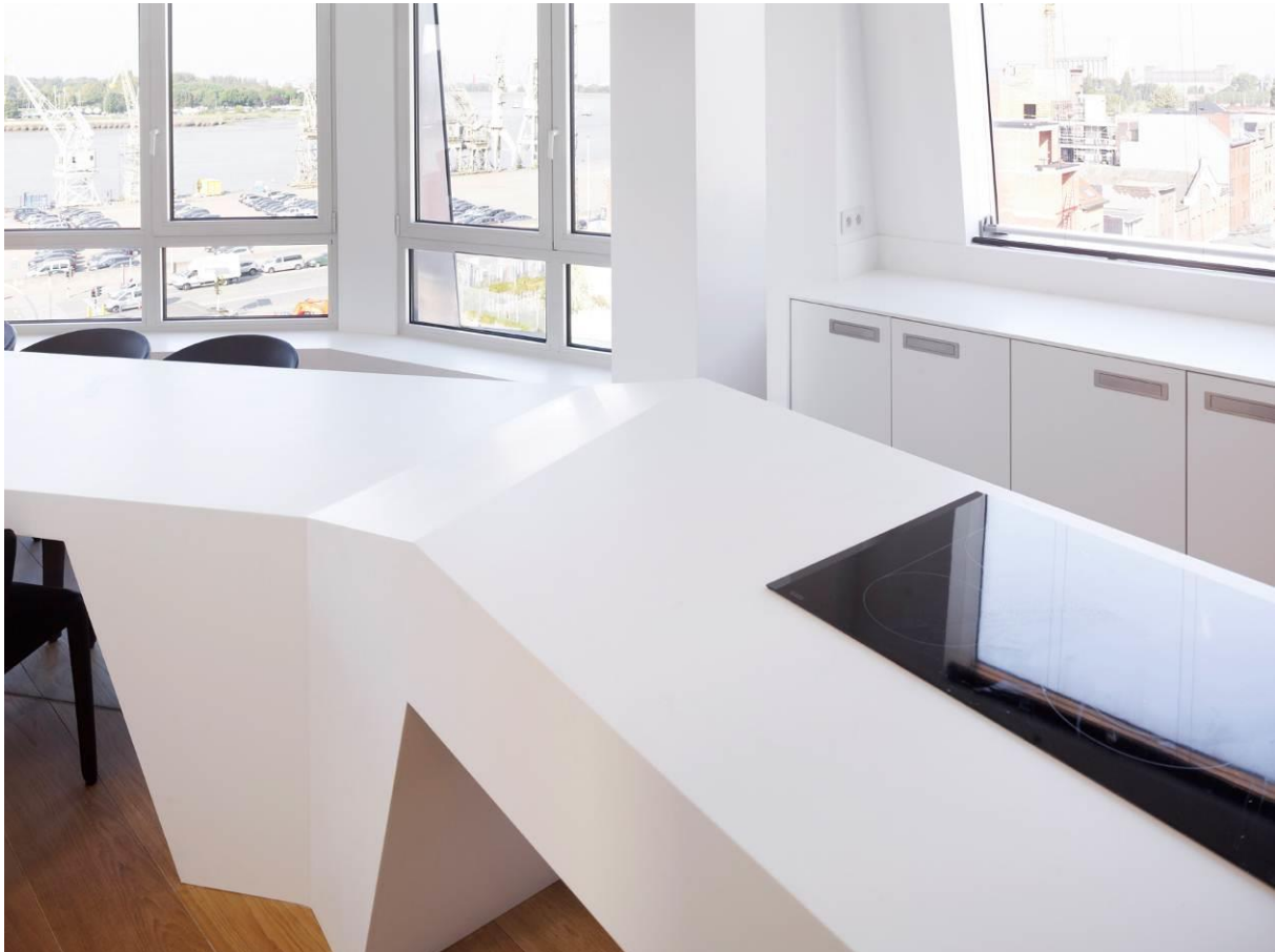
La cocina fue fabricada en dos piezas a fin de poder transportarla, ya que el apartamento se ubica en una 5ª planta. Las partes fueron posteriormente unidas, pegadas y lijadas in situ.
