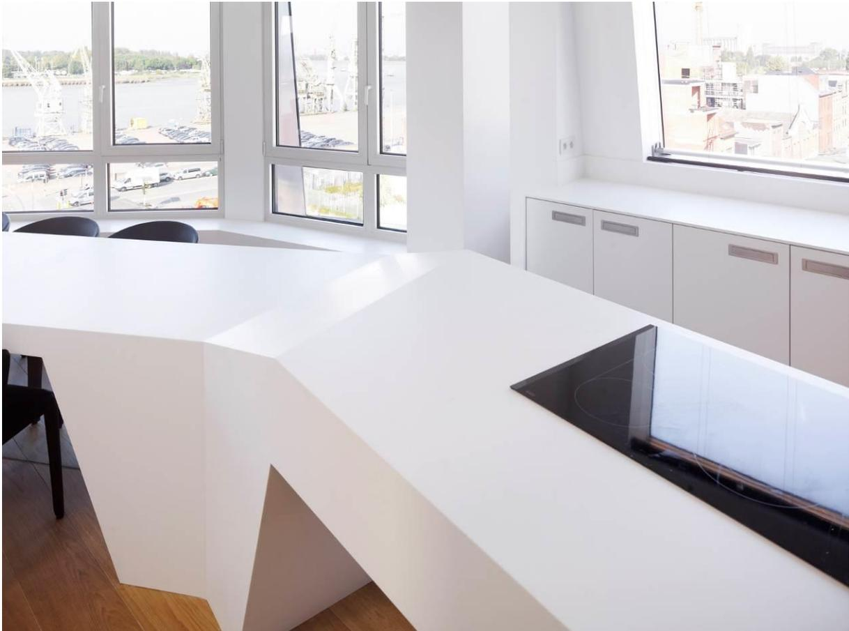
Die Kücheninsel besteht aus Transportgründen aus zwei Teilen, da das Apartment im 5. Stock liegt. Die Teile wurden daher erst vor Ort zusammengefügt, verklebt und geschliffen.
